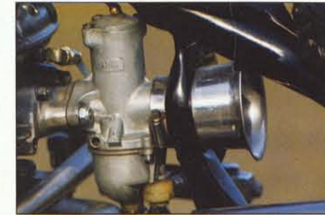
■ De luchtkelk steekt door de framebuis, erg mooi!
