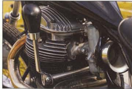
■ Schakelen gaat met de hand, de schakelstang is door Albert zelf gemaakt
