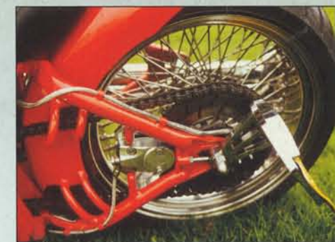
■ VG zaagde, boog en laste een extreme achterbrug op maat
